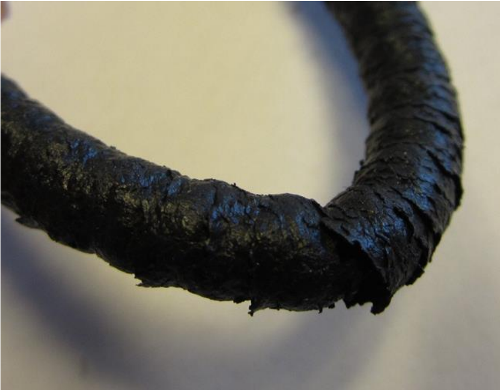
Stark gequollener O-Ring FKM in Phoron (Lacklösungsmittel)
