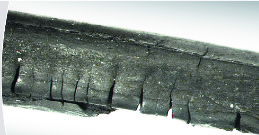
Extrem starker thermischer Angriff auf einen O-Ring
