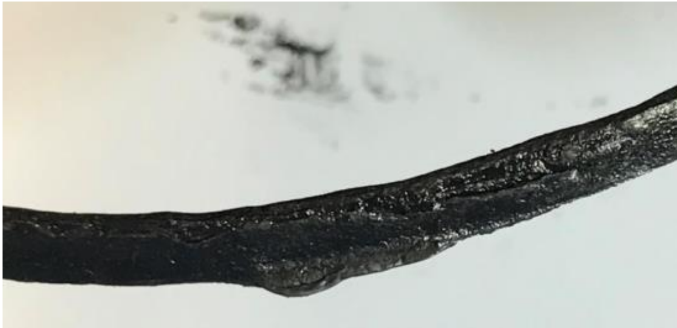
Stark angegriffene EPDM Dichtung
