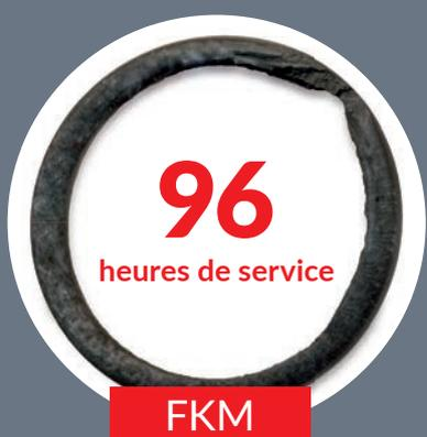
Conclusion : dégât sur la machine, arrêt de production
