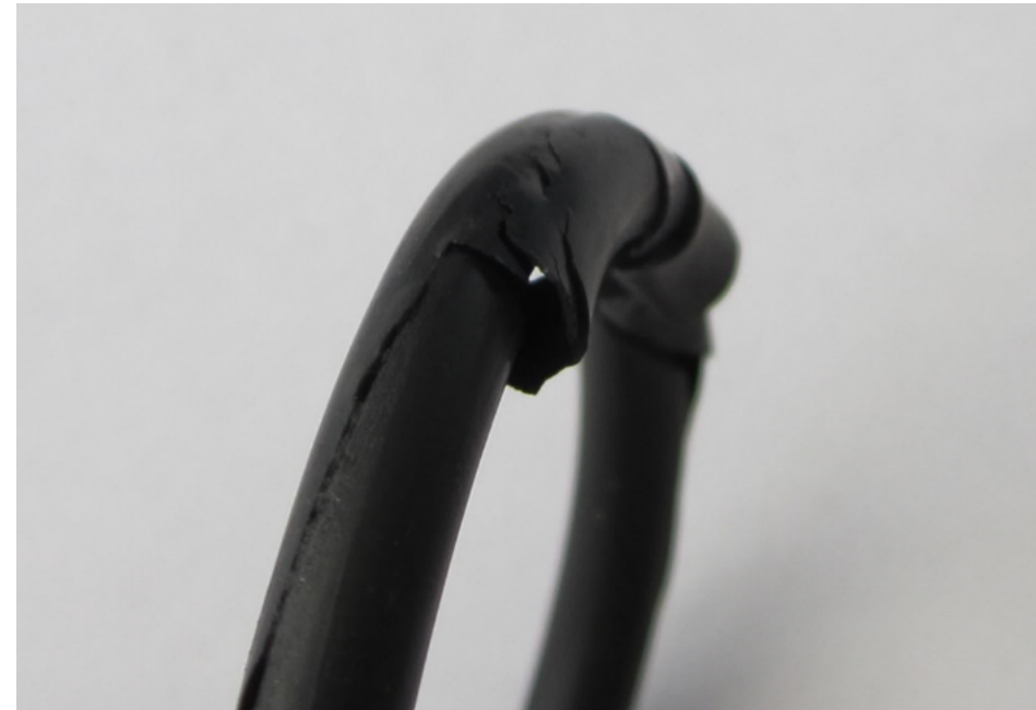
Typisches Schadensbild einer Spaltextrusion
