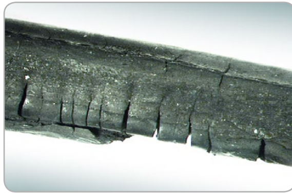
Oring zniszczony przez zbyt wysoką temperaturę
