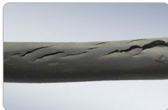
Oring zniszczony przez oddziaływanie chemiczne
